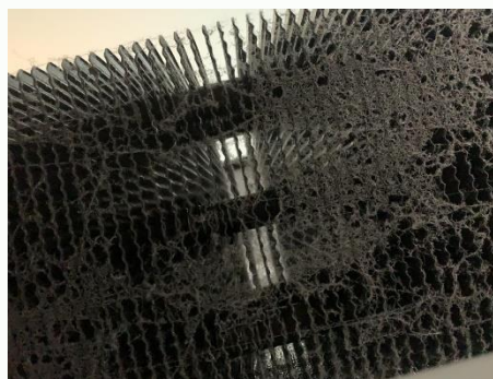
De stophopping onderkant behuizing
